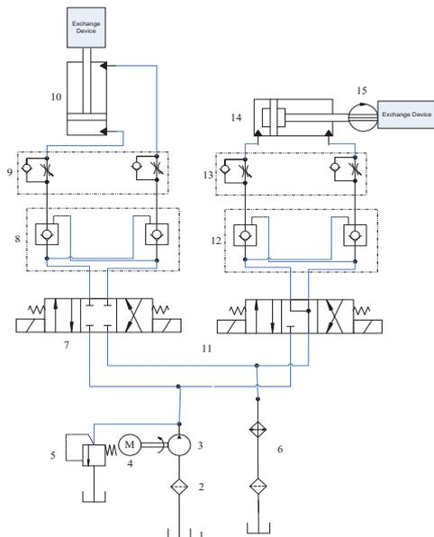
1. Tank 2. Filter 3. Vane Pump 4. Motor 5. Relief Valve
